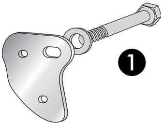
Anschließend die beiden Halteadapter wie gezeigt am C-Bow anbringen.
