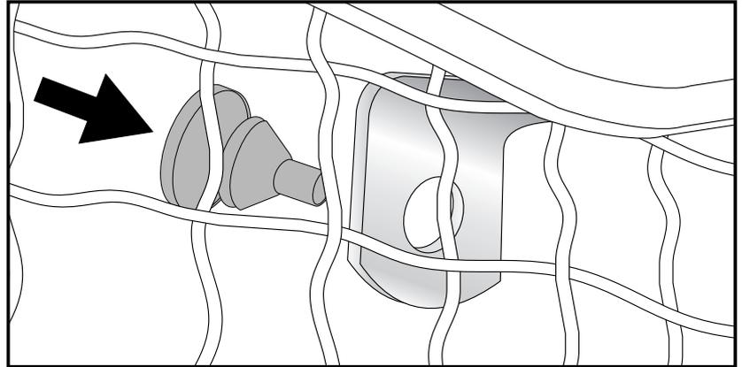
Das Lampengitter wird mit den Sechskantschrauben M6x16 sowie den U- Scheiben ø6,4 direkt an den freien Gewinden an der Rückseite des Tankschutzbügels befestigt.
