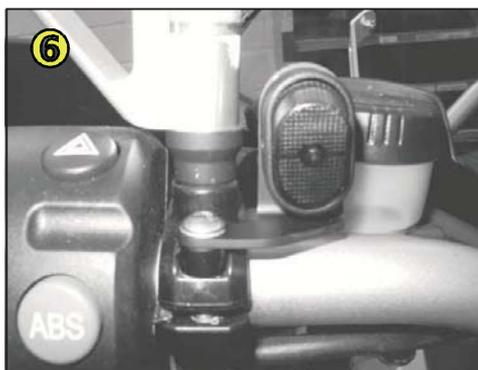
Demontieren Sie die hintere Torxschraube der linken Spiegelbefestigung am Lenker, trennen Sie die Steckverbindungen der Schalterleitung und montieren Sie den Schalter mit einer Schraube M5 x 30, U-Scheibe und kleiner Hülse als Distanz am Lenker.
