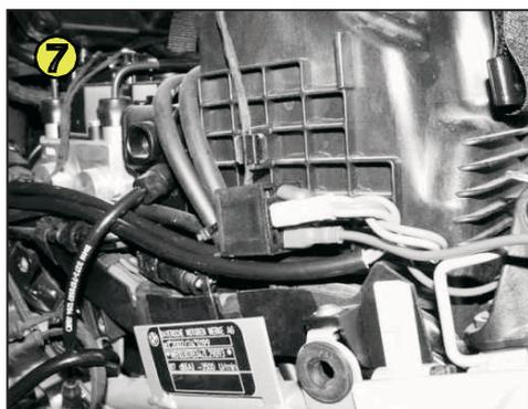
Befestigen Sie das Relais mit Kabelbindern auf der linken Fahrzeugseite an den vorhandenen Leitungen, verlegen Sie die Schalterleitung vom Relais entlang der Originalverkabelung zur Schalterleitung vom Schalter und verbinden Sie die Steckanschlüsse, verlegen Sie die Scheinwerferzuleitung entlang der Originalverkabelung und der Frontverkleidungsbefestigung zuerst zum linken Zusatzscheinwerfer und von hier aus zum rechten Zusatzscheinwerfer.
