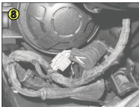
Verlegen Sie das schwarze Kabel (vom Schalter) zur vorderen Standlichtfassung ziehen Sie diese heraus, klemmen Sie das schwarze Kabel mit einem Kabelschnellverbinder an das blau-graue Kabel der Standlichtleitung und setzen Sie die Standlichtfassung wieder ein.
