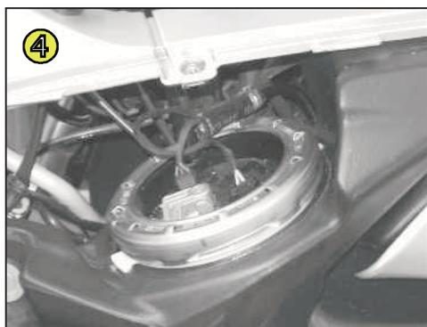
Demontieren Sie mit der gleichen Vorgehensweise die Benzin Schlauchkupplung auf der linken Seite und ziehen Sie die Benzinpumpenstecker ab.
