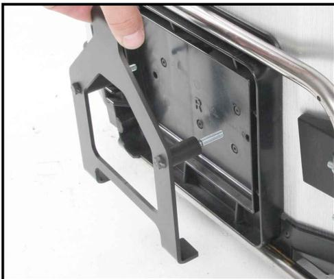
Die Rändelmuttern von innen auf die überstehenden Gewinde aufdrehen. Hinweis: Die Rändelmuttern mit der großen Auflagefläche gegen die Kunststoffinnenwand des Koffers schrauben, um die Druckbelastung gering zu halten und Spannungsrissen vorzubeugen!
