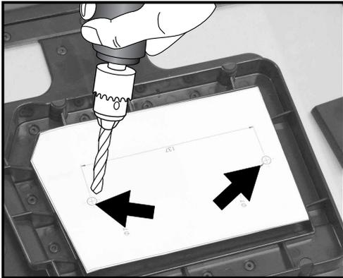
Mit einem Bohrer  $\varnothing 3\text{mm}$  die beiden Löcher vorbohren. Lochabstand mit der Sicherungshaltekralle überprüfen und ggf. korrigieren. Korrekte Löcher mit einem Bohrer  $\varnothing 7\text{mm}$  aufbohren. Hinweis: Beim Bohrvorgang vorsichtig und mit wenig Druck bohren, da sonst Beschädigungen an der Innenabdeckung auftreten können!
