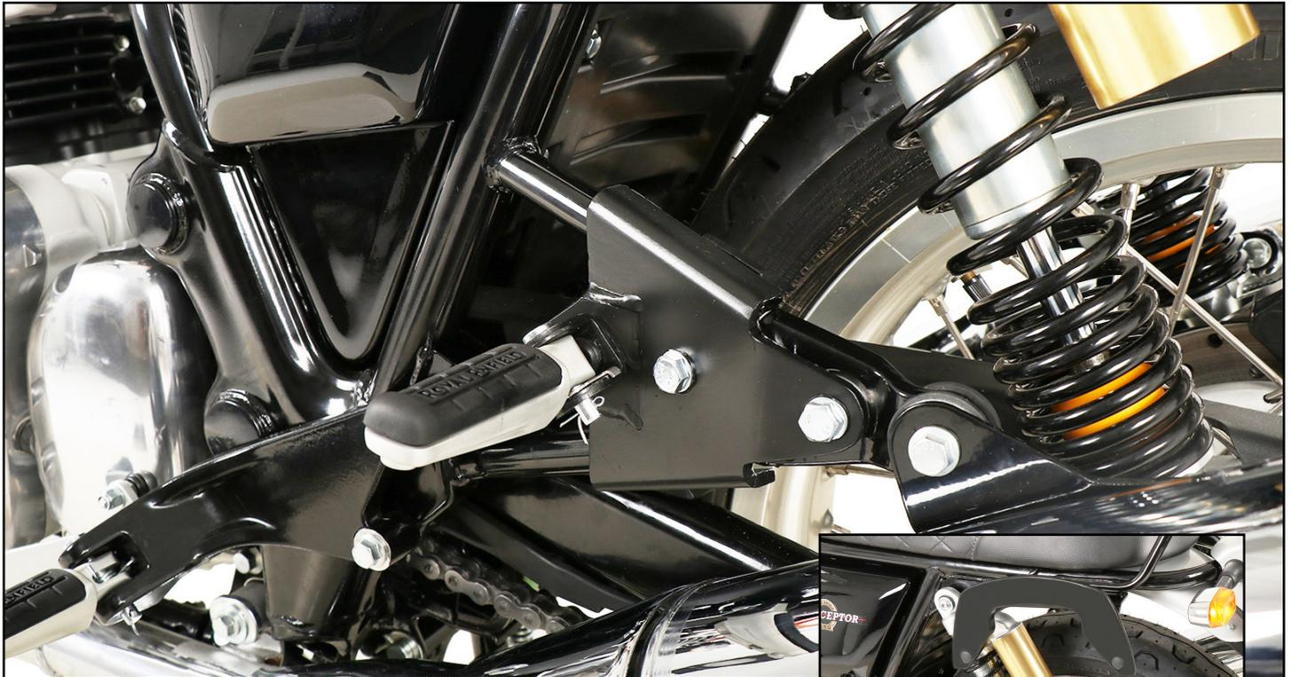
Für das Fahren mit Sozius wird diese Soziusfußrastenverlegung benötigt, wenn ein C-Bow Halter montiert ist.
