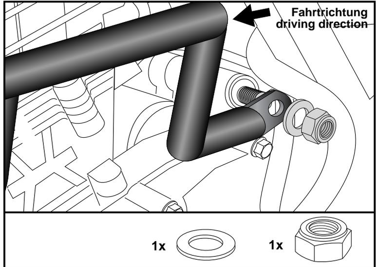
Montage des Motorschutzbügels links vorne:
