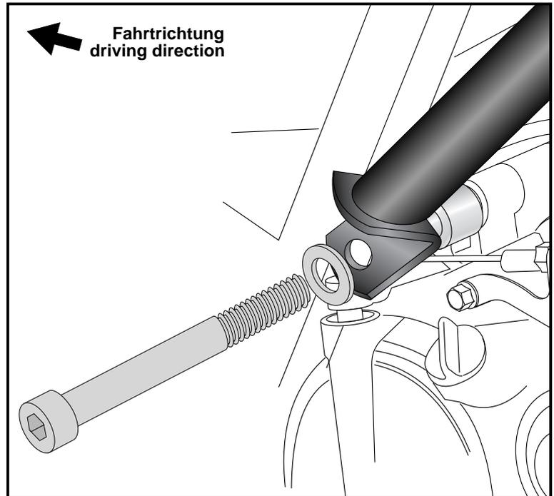
**Montage Motorschutzbügel rechts vorne:**
