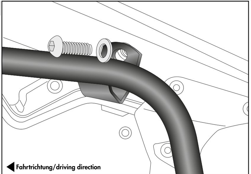
**Montage Motorschutzbügel unten rechts:**
