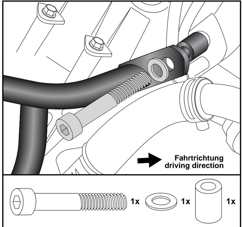
Montage des Motorschutzbügels
