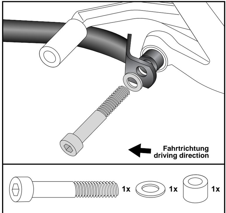
Verbindung der Motorschutzbügel mitte:
