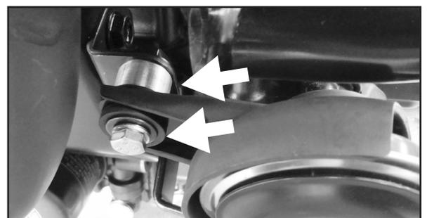
**Motorblock unterbauen. Eine Seite nach der anderen montieren. Rechts beginnen.**
