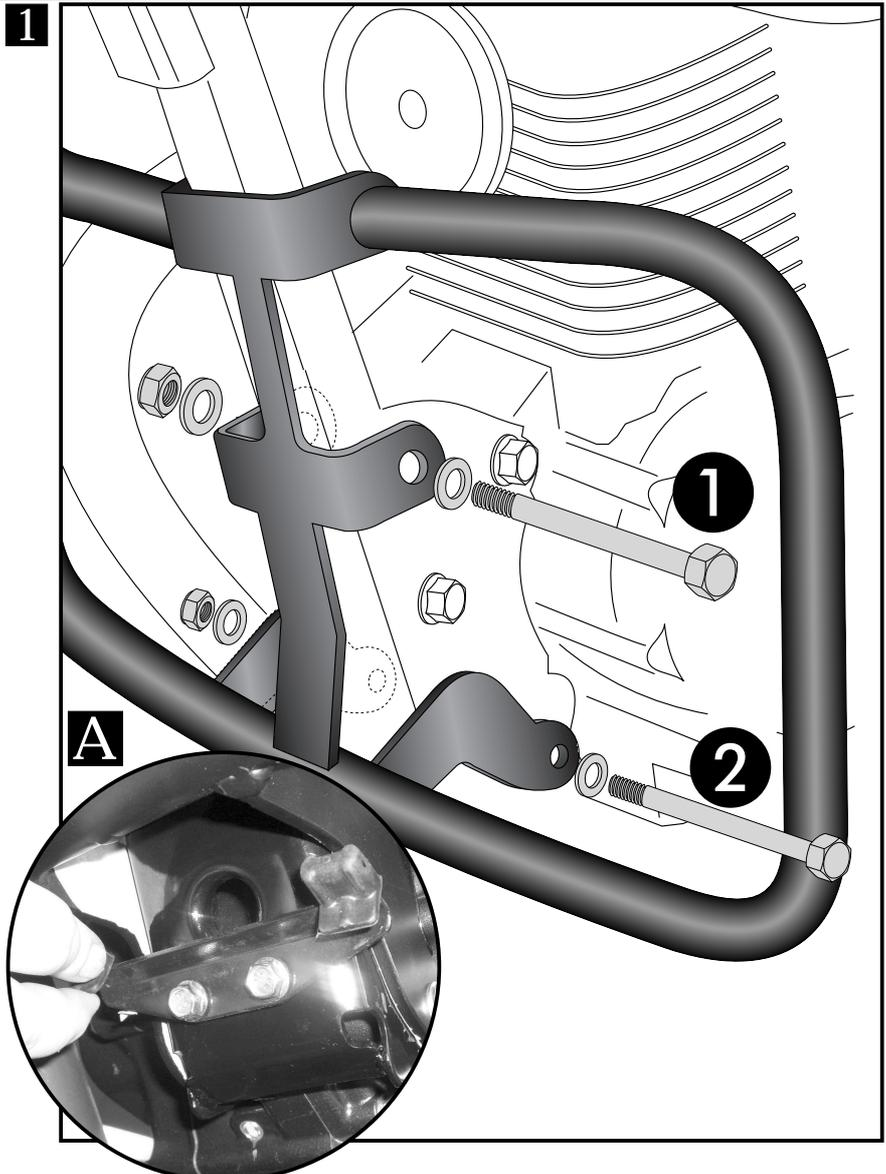
Kupplungszug aushängen und, wie im Bild sichtbar, neu verlegen.
