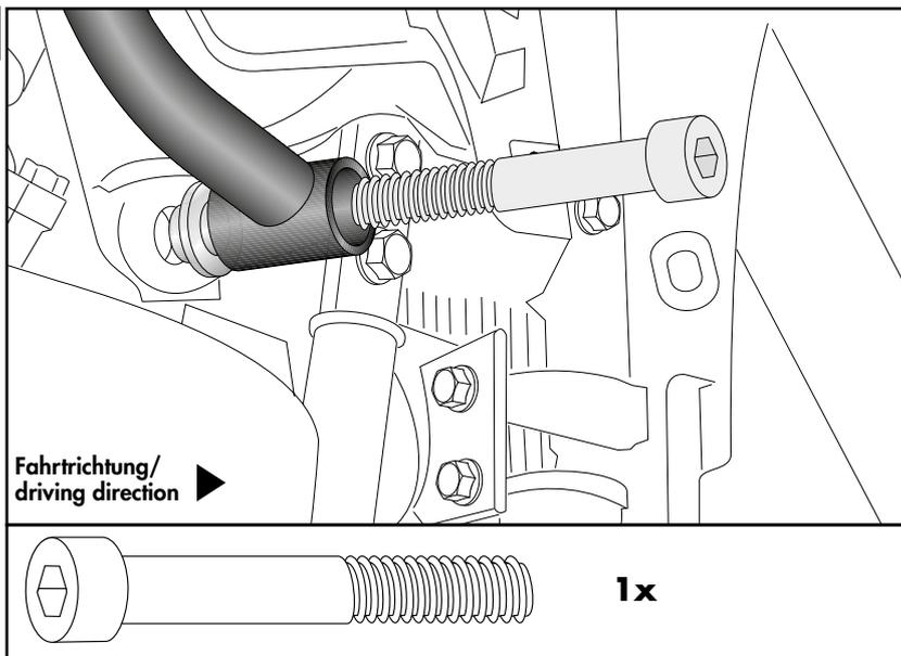
**Montage des Tankschutzbügels oben rechts:**
