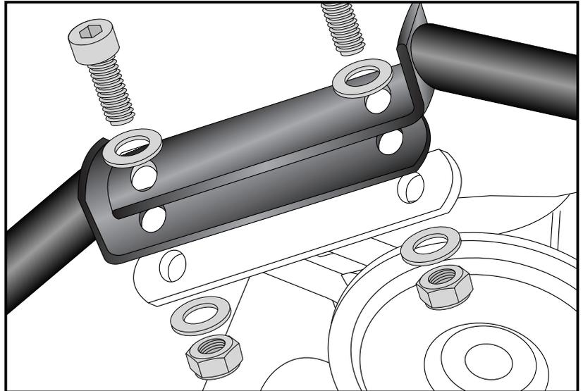
**Befestigung am Original-BMW- Motorschutzbügel links und rechts:**
