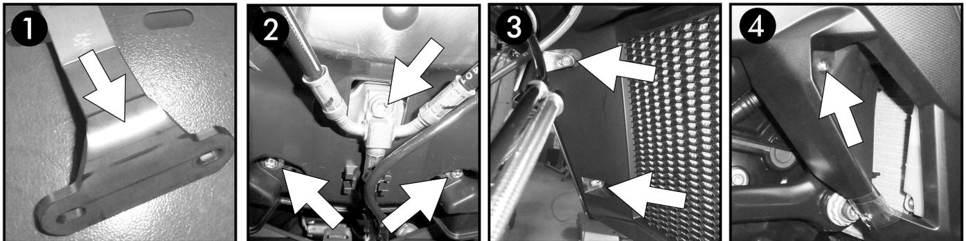
Die Schraubbereiche an der seitlichen Verkleidung mit Klebeband zum Schutz gegen Verkratzen abkleben.
