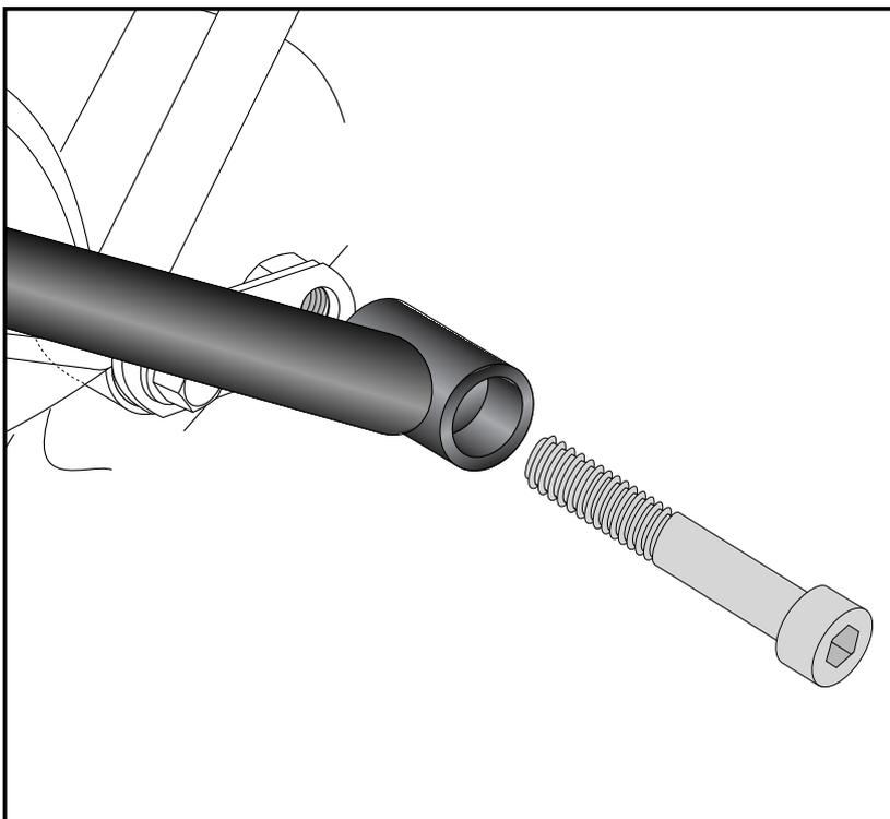
Montage der Tankschutzbügel vorne:
