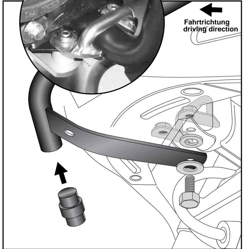
Den rechten Tankschutzbügel vorne mit dem bereits montierten, linken Bügel zusammenstecken.
