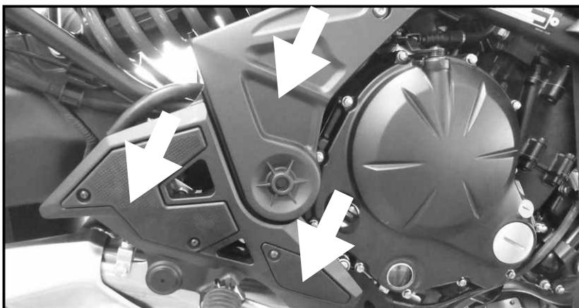
Die drei markierten Originalschrauben entfernen, sowie die Originaldistanzen. Schrauben und Distanzen entfallen.
