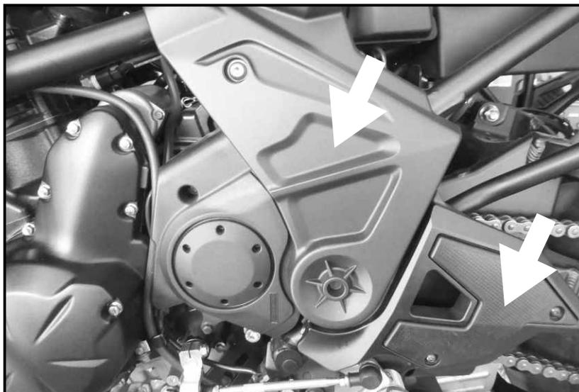
Die drei markierten Originalschrauben entfernen, sowie die Originaldistanzen. Schrauben und Distanzen entfallen.
