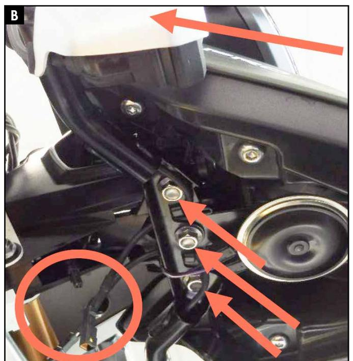
Die zwei Schrauben mit Mutter der Cockpithalterung entfernen, die Schrauben entfallen, die Muttern werden wiederverwendet.
