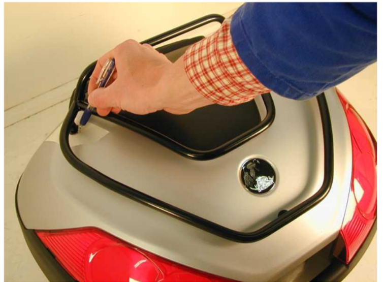
Abb. 2: Markieren der Bohrungen
