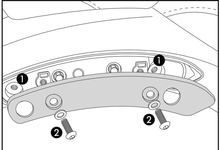
Befestigung vorne links und rechts: mit der Zylinderschraube M10x1,25x60 sowie U-Scheiben  $\varnothing 10,5$ . Zwischen Lasche und Rahmen die Aludistanz  $\varnothing 18 \times \varnothing 11 \times 25$  fügen.
