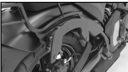
Bei zusätzlicher Montage eines C-Bow Halters werden diese außen auf den Laschen der Sissybar mitverschraubt. Hierzu die Schrauben des C-Bowhalters verwenden.
