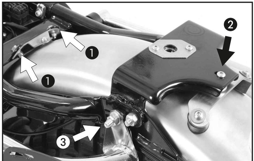
Der Haltegriff wird vorne wieder verschraubt. An der oberen Federbeinaufnahme zwischen Aufnahme und Haltegriff zwei U-Scheiben Ø24 x Ø 8,4 x 2mm einsetzen und mit der Originalschraube verschrauben.
