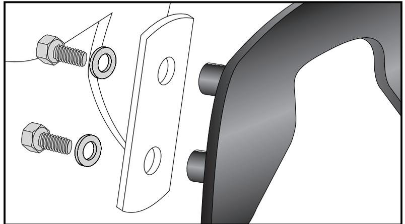
Bei gemeinsamer Montage mit dem Easy-Mini- oder Alurack wird der C-Bow Halter auf den Haltern des Racks verschraubt. Die Aludistanz Ø18xØ9x30mm vorne entfällt.
