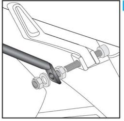
Befestigung der Rohrstreben links + rechts:
