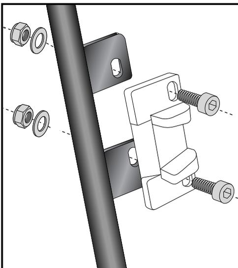
Montage des Metalladapters zum Einhängen des Kofferhalteschlusses
