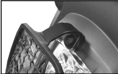
Gummipuffer an der Oberseite einziehen.
