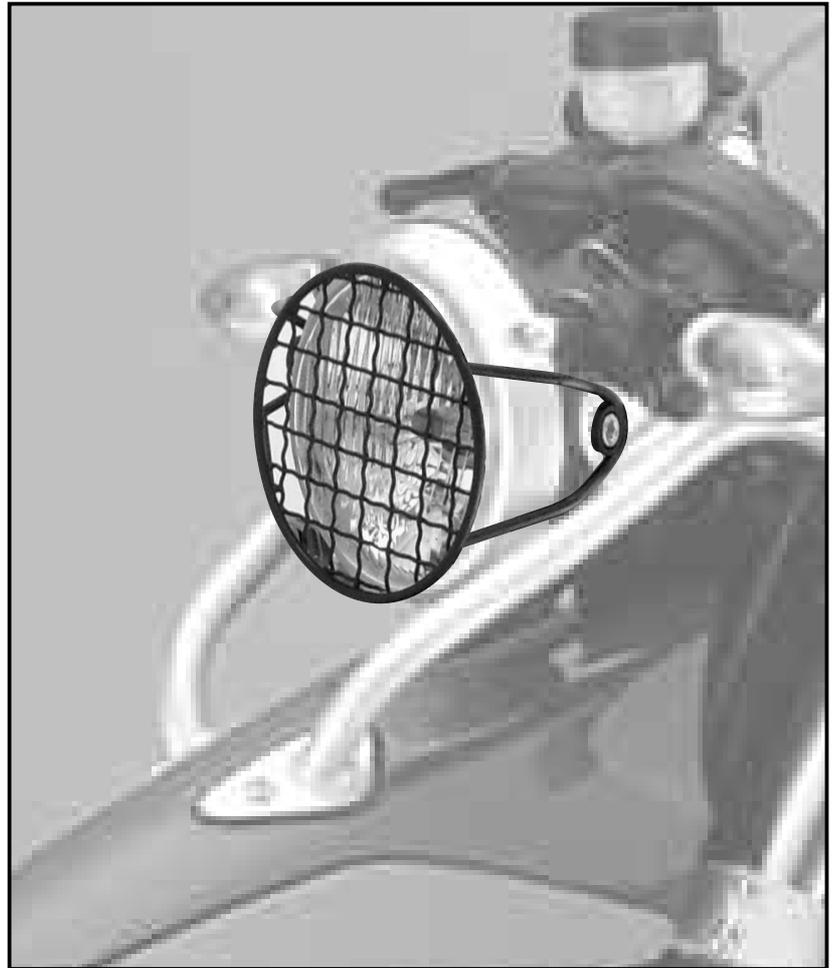
Das Lampengitter ist für den Offroad-Einsatz entwickelt worden und hat keine TÜV-Zulassung.
