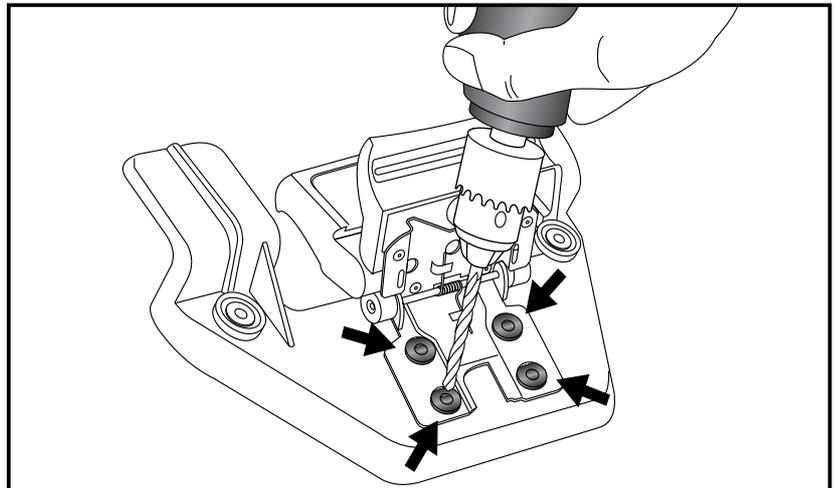
Die Unterlegplatte an der Topcaseinnenseite positionieren und das neue Schloss auf der Außenseite. Das neue Halteschloss von Innen mit den beiliegenden Nieten 4 x 20 mm befestigen.
