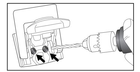
Das neue Halteschloss mit den beiliegenden Nieten befestigen. Die Nieten von außen durch die Bohrungen stecken. Auf der Kofferinnenseite die beiliegenden U-Scheiben aufstecken und vernieten.
