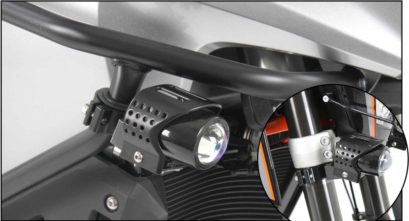
Beispiel: Befestigung an Motor-/Tankschutzbügel
