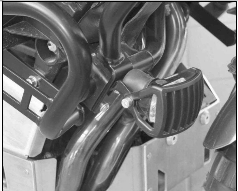
Abbildung mit Zubehör Schutzgitter für Microflooter 730.100
