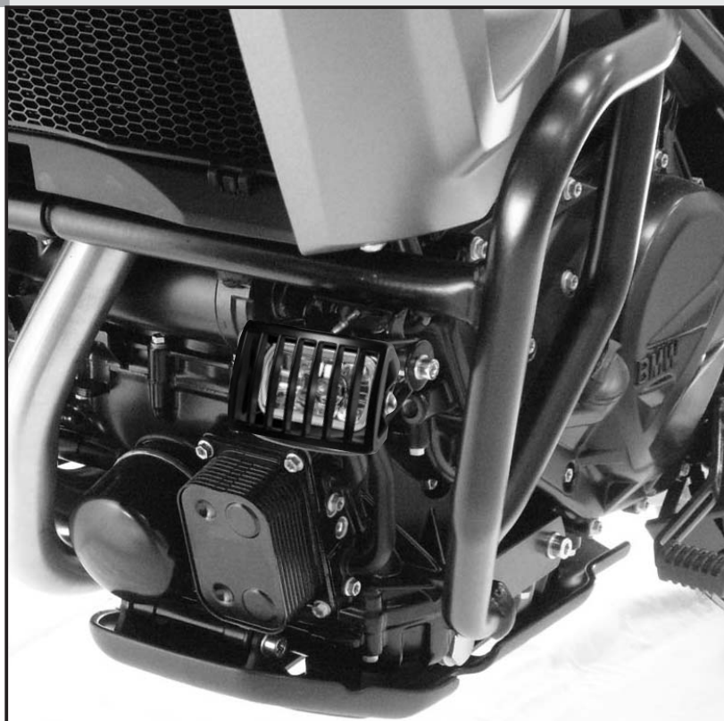
Abbildung mit Zubehör Schutzgitter für Microflooter 730.100.
