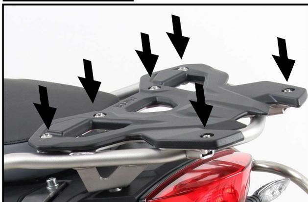
Die Kunststoffabdeckung der Originalbrücke entfernen, hierfür die im Bild markierten Schrauben lösen. Abdeckung und Schrauben entfallen.
