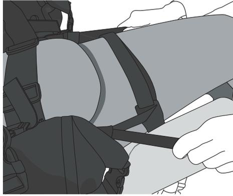
2 Hänge beide Haken am hinteren Kotflügel ein und verzurre die Taschen nach hinten. Falls Dein Motorrad keinen für die Haken geeigneten Kotflügel hat: Tausche den Hakenriemen gegen den beiliegenden Riemen und verzurre die Taschen zum Gepäckträger.
