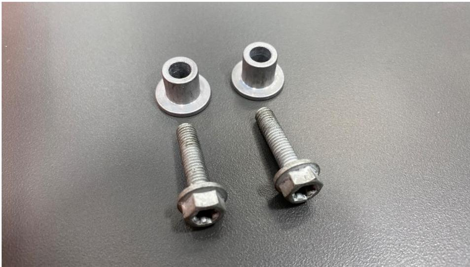
(T45 TORX) Remove the left rear subframe bolt.
